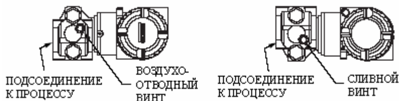
Рис. 18. Вертикальный монтаж - Вентиляция полости
